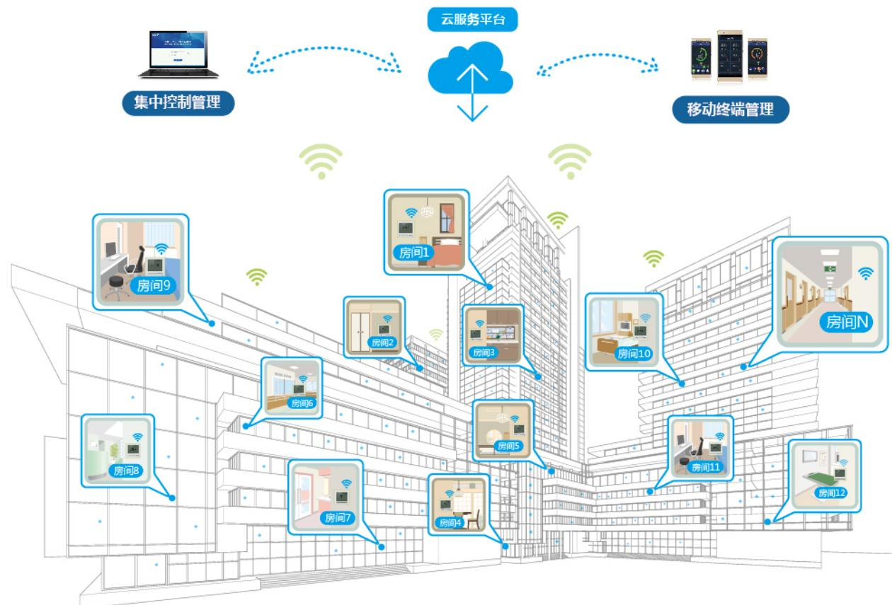
海林·WTS无线网络温控器监控系统 通过无线网络温控器和云服务平台，实现对建筑内网络温控器的集中管理和实时监控，集中设定和调节室内环境温度，达到舒适和节能的目的。同时，个人还可通过手机等移动终端，设定和调节室内温度，满足个性化需求。适用于办公楼、学校、医院等公共建筑，无需布线可实现房间温控器的远程监控。
